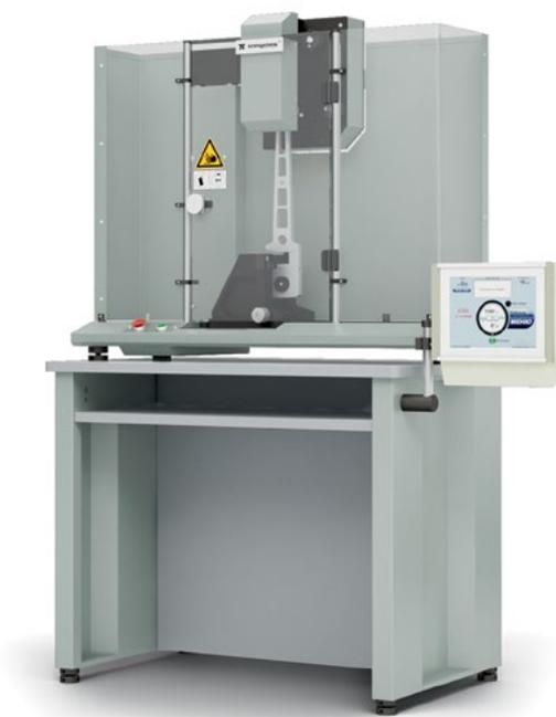
Маятниковые копры **ТСКМ** для измерения энергии разрушения образцов металлов, сплавов и пластмасс при испытании на ударный изгиб или ударное растяжение. Проведение испытаний по схемам Шарпи, Изода и другим схемам в соответствии с ГОСТ 10708-82, ГОСТ 9454-78, ГОСТ 19109-84 и ASTM E23 позволяет получить полную картину исследования ударных свойств материалов.
