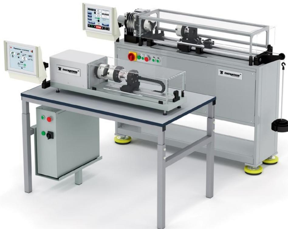
Машины серии **КТС 405** являются отличным решением для измерения величины крутящего момента силы и осевого усилия при проведении испытаний различных материалов и образцов на кручение, в том числе испытания болтов с целью контроля качества поверхности резьбы в соответствии с ГОСТ Р 52643.
