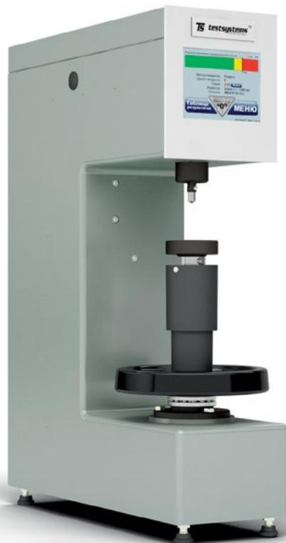
Твердомеры серии **ТРТС** для определения твердости металлов и сплавов по методам Бринелля, Роквелла и Супер-Роквелла в соответствии с ГОСТ 9013, пластмасс по ГОСТ 24622, графитов и металлографитов, фанеры, прессованной древесины и других материалов.
