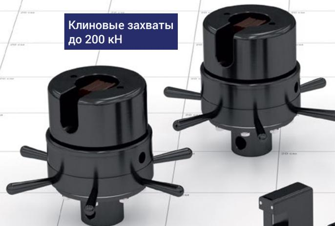
Захваты для испытания лент на растяжение
