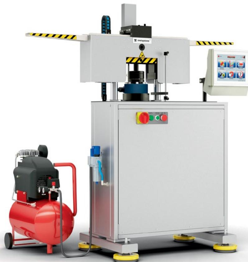
Машина для испытаний на выдавливание по Эриксену (ГОСТ 10510-80)
